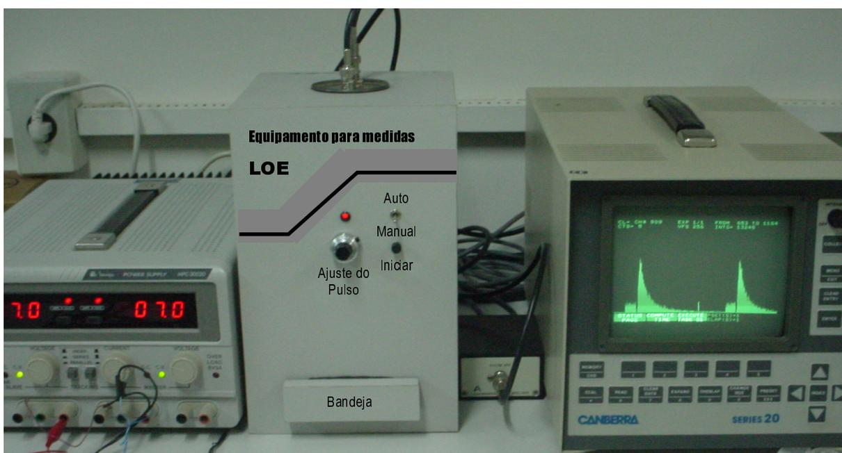
Figura 25 – Fonte de tensão dupla (esquerda) que alimenta o equipamento para LOE (centro) que está acoplado a um multicanal (direita)
