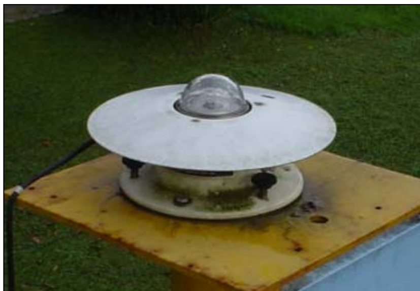
Figura 3.2 - Piranômetro espectral de precisão Eppley (PSP)
