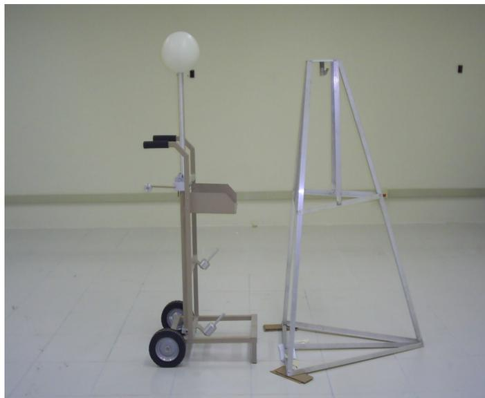
*Figura 11: Esquema do arranjo experimental para irradiações dos detectores utilizando a fonte de  $^{241}\text{AmBe}$ .*
