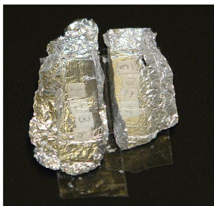
*Figura 12: Esquema fotográfico dos oito TLD separados por tipo e encapsulados em alumínio.*
