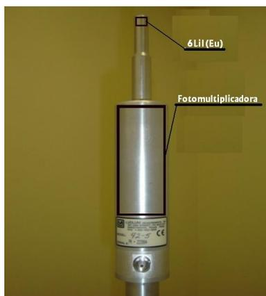
*Figura 5: Sistema de Detecção [ ${}^6\text{Li}(\text{Eu}) + \text{FM}$ ].*
