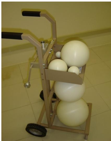
*Figura 7: Esferas de polietileno do sistema EB.*
