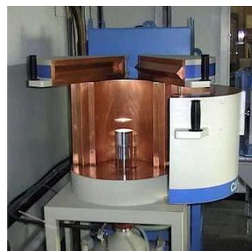
Figura 13b: Detector HPGe na blindagem (ENV. MONITORING, 2004).
