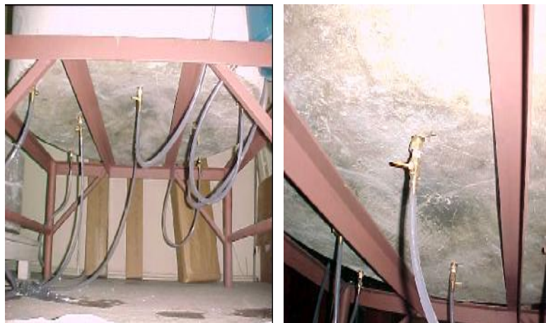
Figura 4 - Canais de drenagem na base do lisímetro
