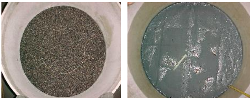
Figura 6 - Camada de brita e o bidim®
