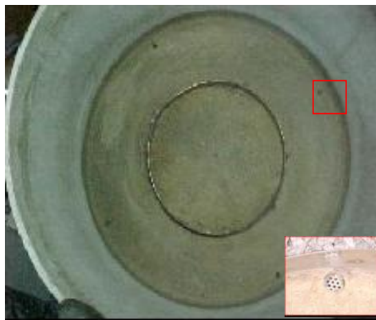
Figura 5 - Vista superior do interior do lisímetro. No detalhe é apresentado um dos canais de drenagem localizado na região central do lisímetro.
