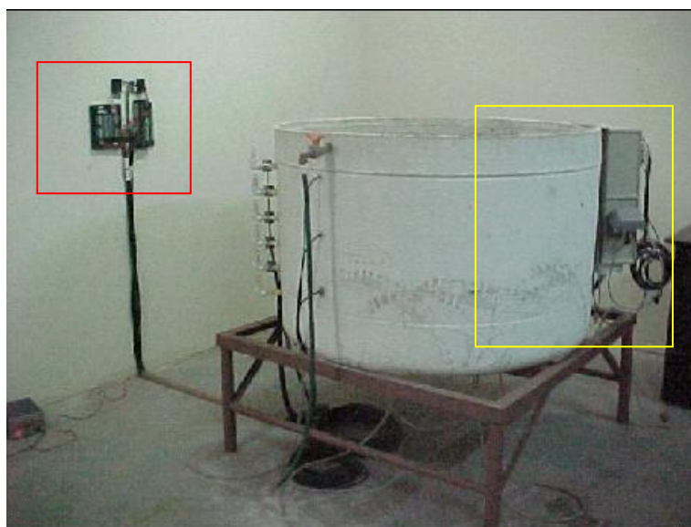
Figura 7 - Sensores automatizados para as medidas de umidade volumétrica e do potencial matricial
