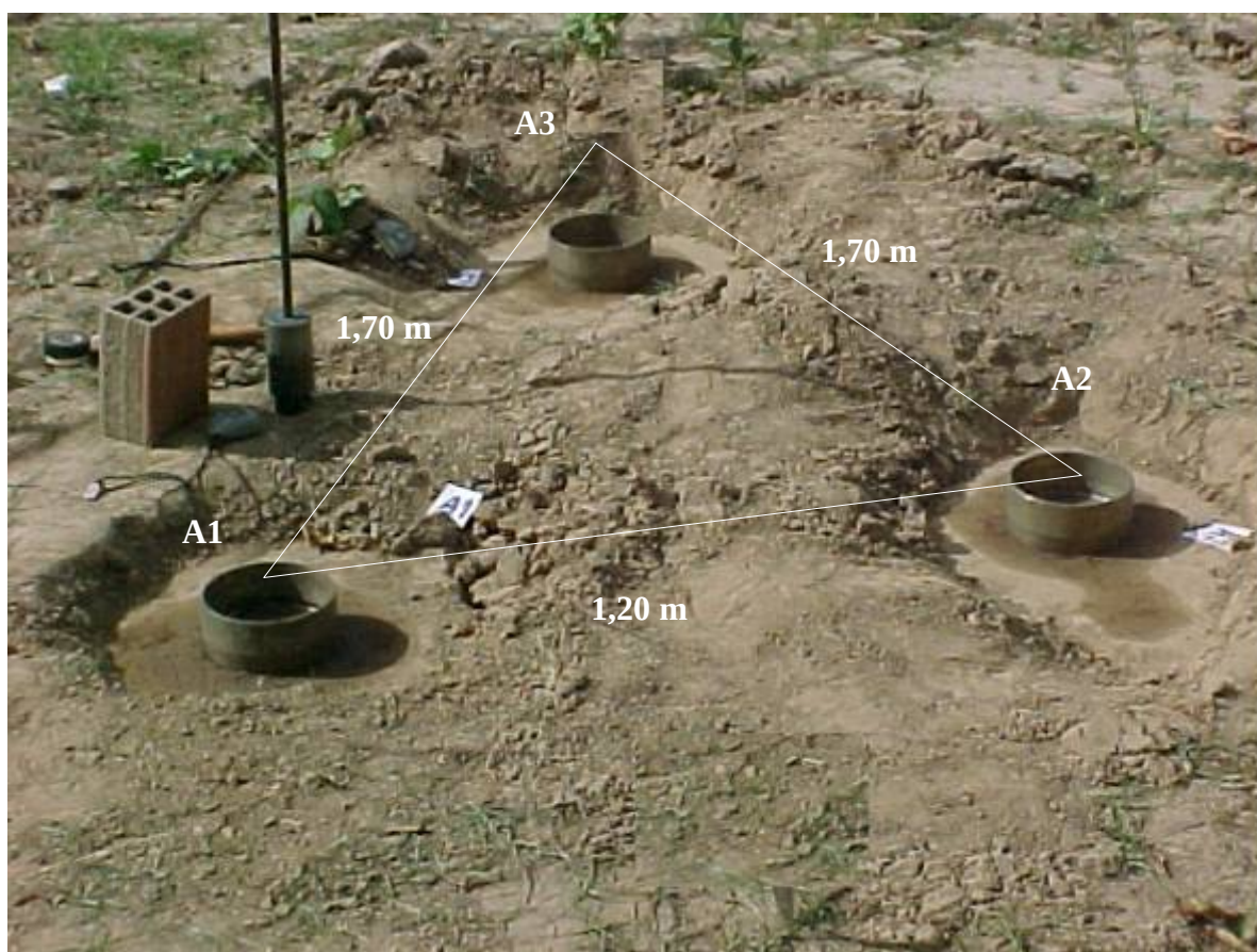
Figura 13 - Esquema do arranjo experimental de infiltração
