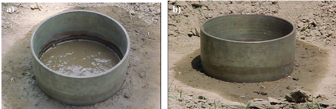
Figura 12 – Ensaio de infiltração
