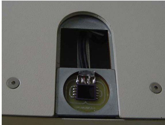
Figura 12. Detector de estado sólido usado no sistema de controle automático da exposição.
