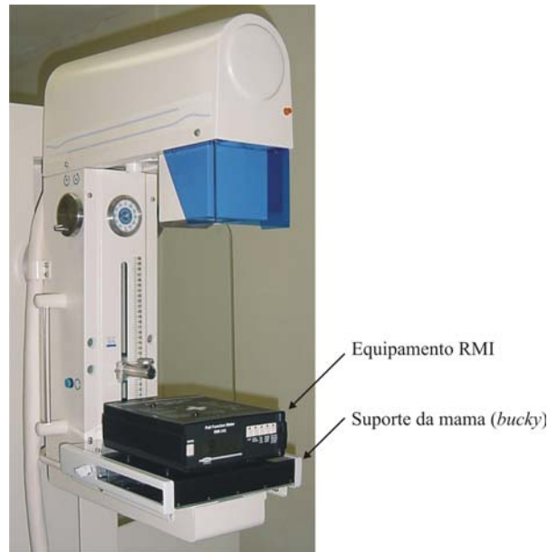
Figura 41. Foto do arranjo usado para medir a tensão do tubo utilizando o equipamento RMI.
