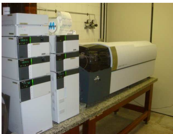
Figura 2.11. Cromatógrafo a líquido acoplado ao espectrômetro de massas com analisadores do tipo captura de íons e tempo de voo (LC-MS-IT-TOF)
