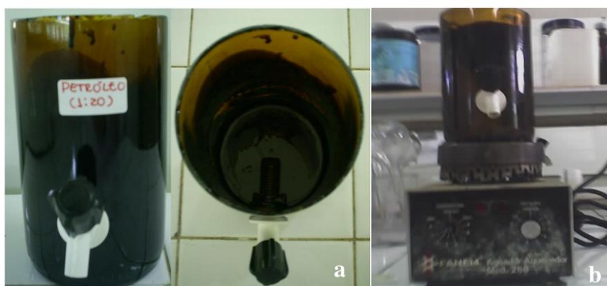
**Figura 5.4** Obtenção da FSA: a) Cuba de vidro confeccionada; b) Preparação da amostra.
