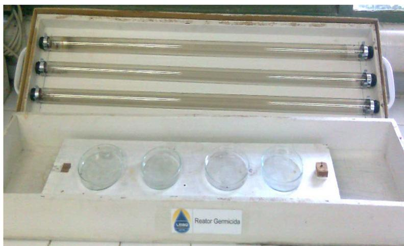
**Figura 5.5** - Reator descontínuo contendo lâmpadas UV-C.
