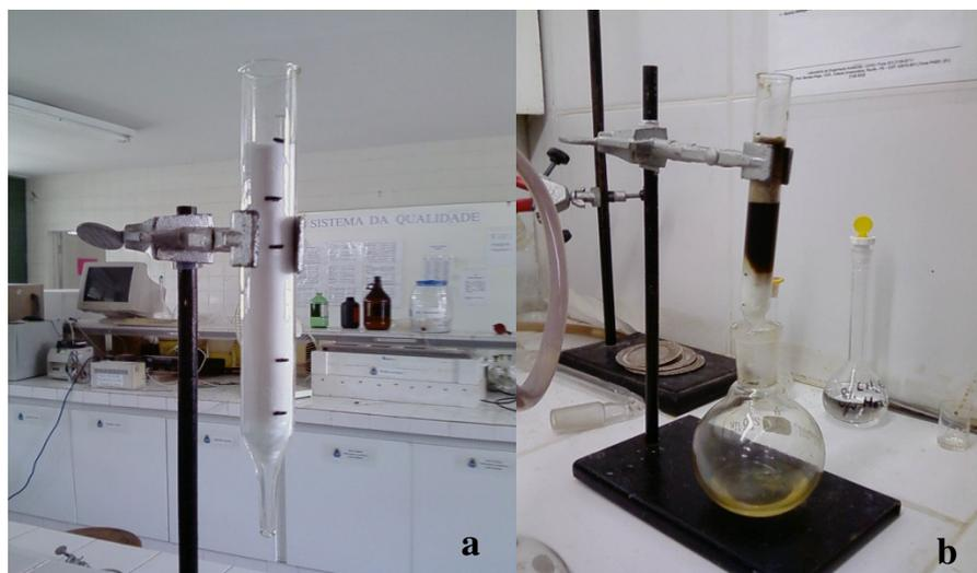
**Figura 5.2** - Coluna Clean-up: a) sem passagem da solução; b) com a passagem da solução.
