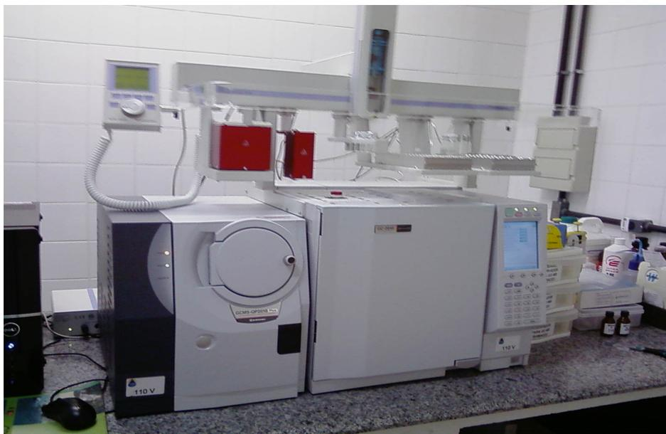
**Figura 5.3** - Cromatógrafo a gás acoplado a um espectrômetro de massa da marca Shimadzu, modelo GC-2010 e QP2020 Plus.
