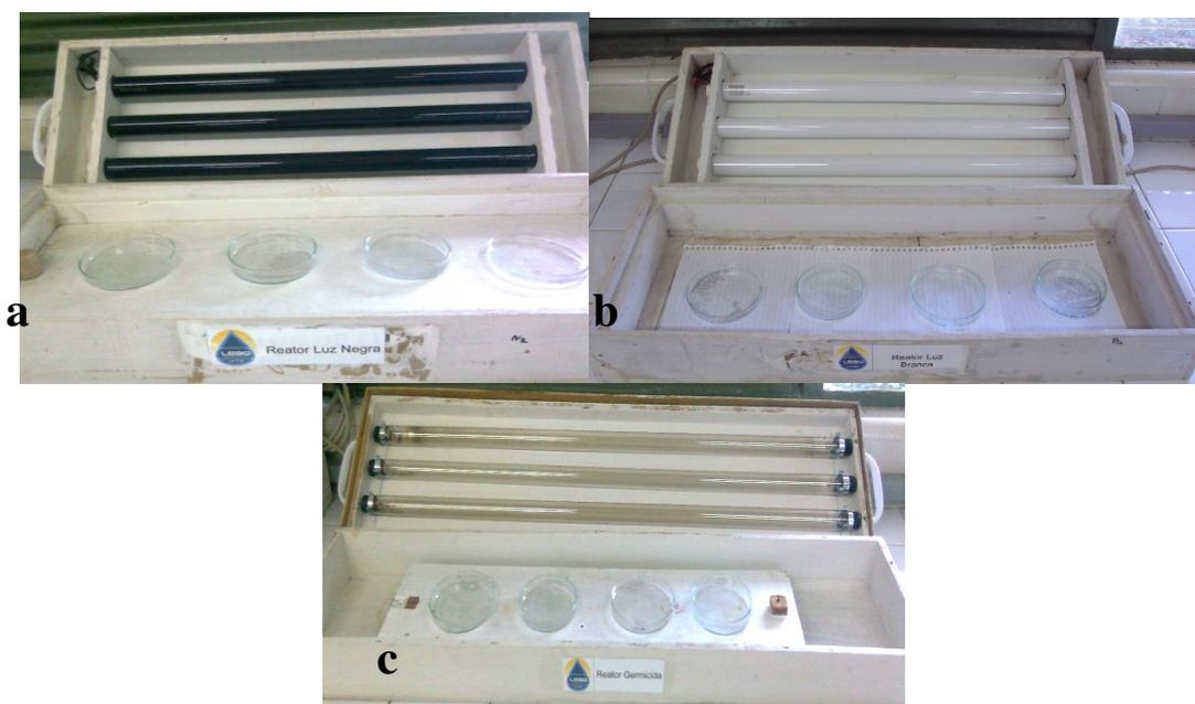
**Figura 5.9** - Reatores descontínuos utilizados neste experimento: a) reator utilizando luz negra; b) reator utilizando luz branca; c) reator utilizando luz UV-C.
