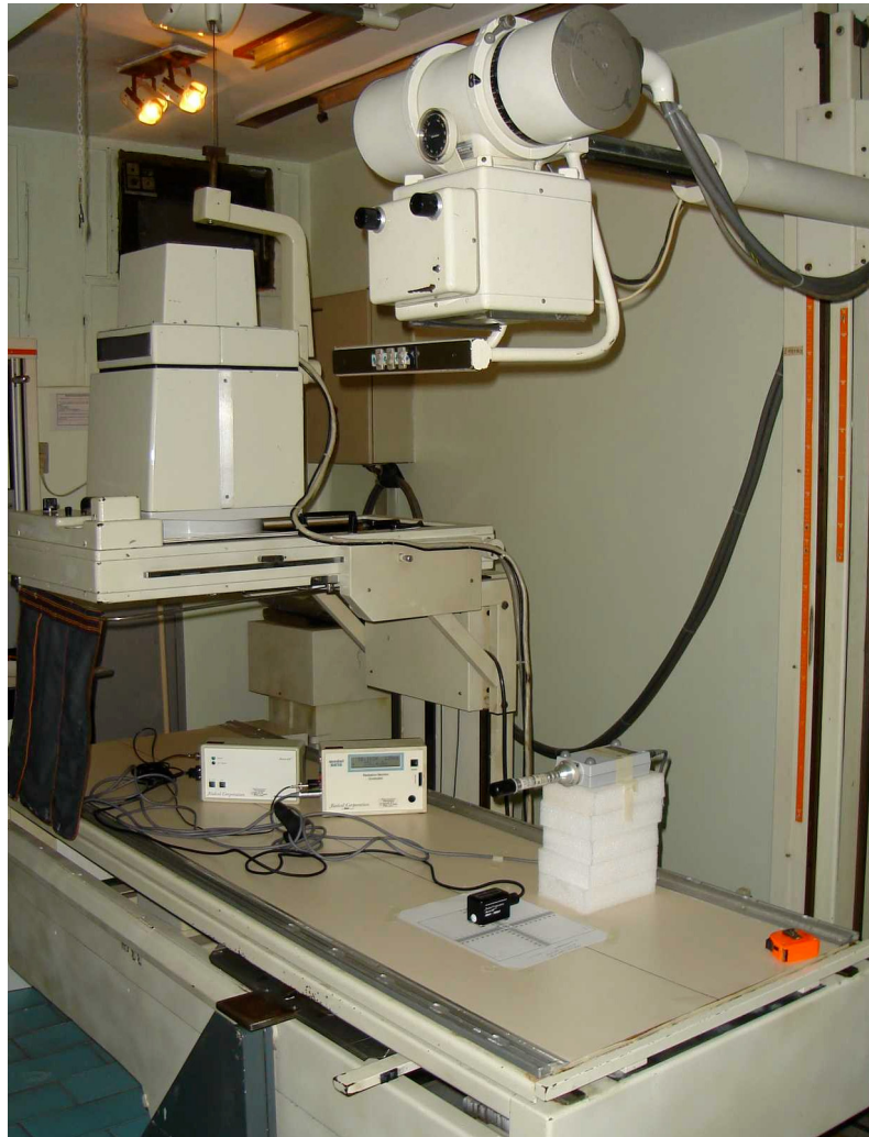
Figura 3. Arranjo experimental para realização das medidas simultâneas de Kerma no ar, kV e tempo.
