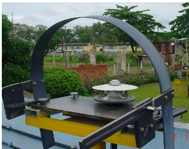
Figura 27 – Piranômetro de marca Eppley e banda de sombra para medição da radiação difusa.
