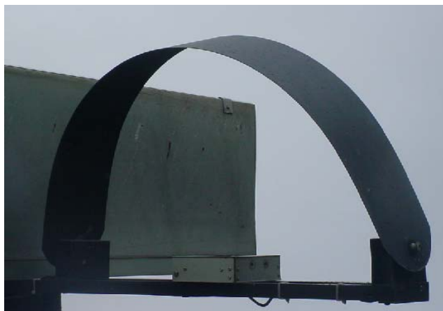
Figura 28 – Sensor fotovoltaico para medição da radiação difusa na abertura da cavidade tipo V.
