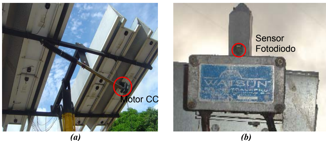
Figura 19 – (a) Motor CC e o braço mecânico do tipo telescópico, (b) Sensor Fotodiodo (LDR).
