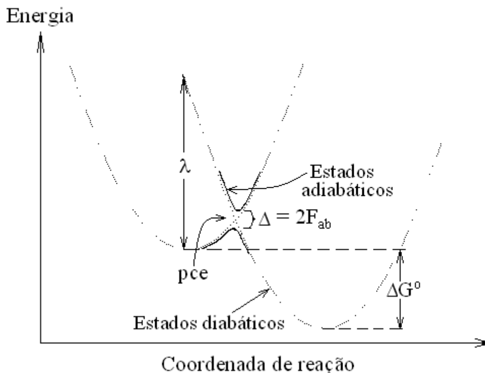
Figura 10.1: Curvas parabólicas representando o estado reagente e produto, para uma reação de transferência eletrônica. Na figura estão indicados os estados diabáticos e adiabáticos, bem como a energia de reorganização ( \lambda ), a diferença de energia livre para a reação ( \Delta G^0 ), o fator eletrônico ( \Delta ) e o ponto de cruzamento evitado (pce).
