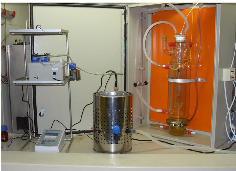
**Figura 5.1 - 1.** Esquema do reator fotoquímico anular.
