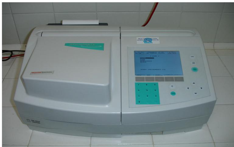
**Figura 5.1 - 2.** Espectrofotômetro UV-Visível (Aquamate - Thermo Spectronic).
