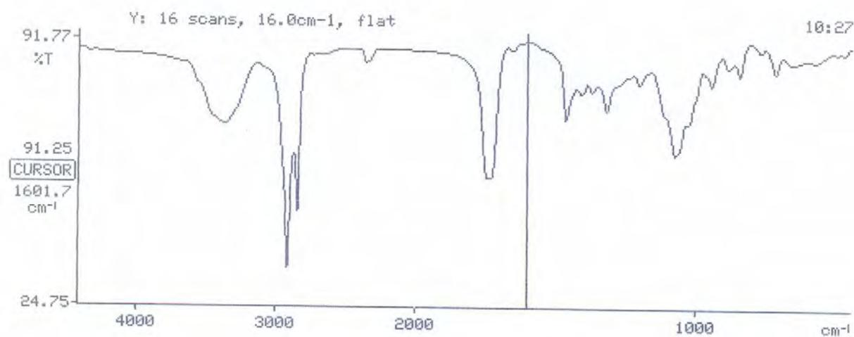
**Figura 27 – Espectro na região do infravermelho da substância AM4 em KBr**
