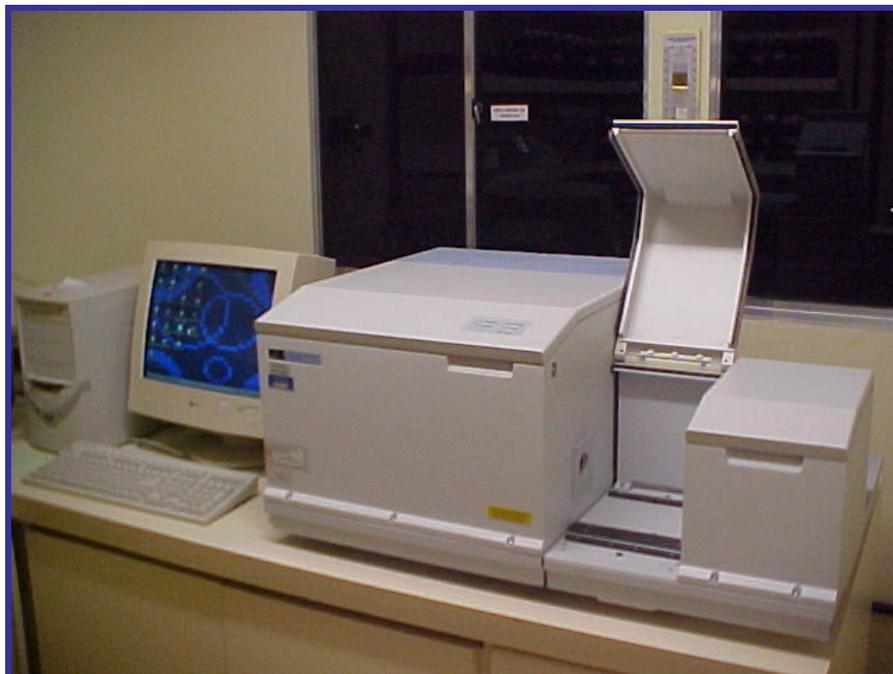
Figura 1.1 – Espectrômetro FT-IR Spectrum GX da Perkin Elmer.
