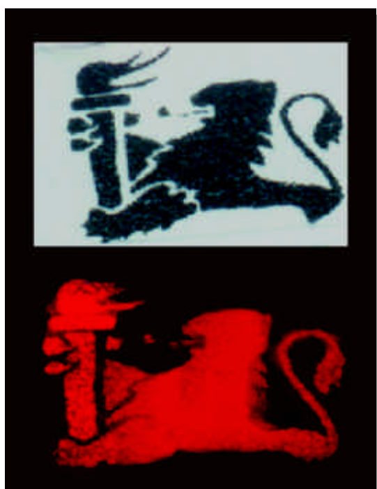
fig. 5.50- Fotolitografia UV- após a retirada da máscara (acima), a imagem é formada pela luminescência vermelha do Eu (III) (abaixo) na área que havia sido protegida pela máscara.
