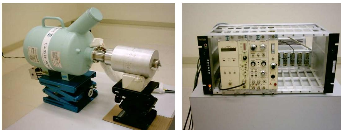
Figura 13 – Sistema de espectrometria da Eurisys Mesures: Detector de HPGe e criostato (esquerda) e sistema eletrônico (direita).
