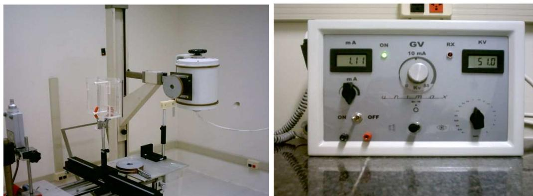
Figura 12 – Sistema de raios-X monofásico de potencial variável da DITAN/CRCN. Cabeçote (esquerda) e painel de comando (direita).
