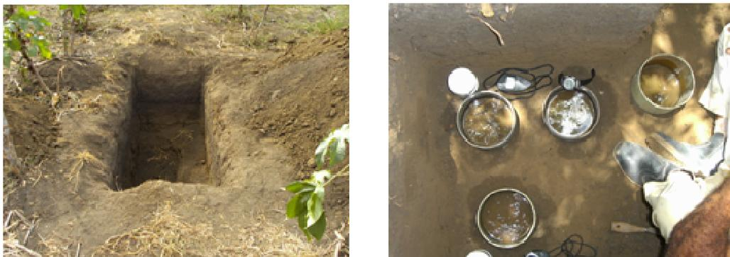
**Figura 3 – Trincheira e ensaios de infiltração**
