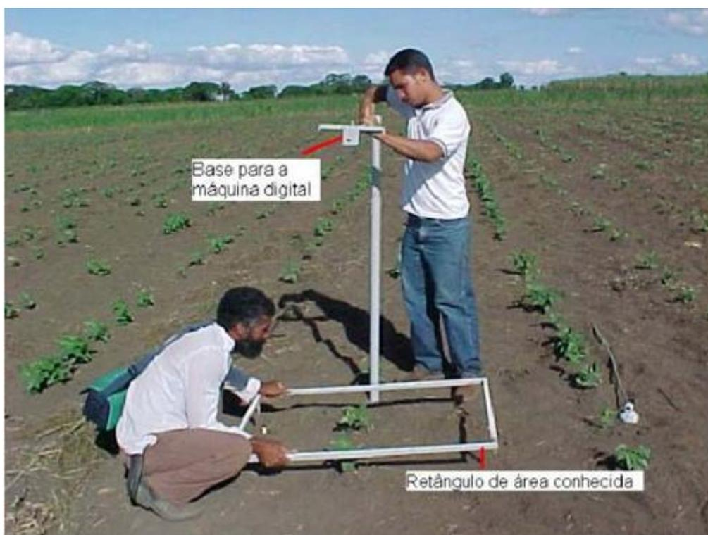
**Figura 4 - Dispositivo para medir a área ocupada pelas plantas do feijão macassar, onde se vê o retângulo sendo colocado no solo, além da base para a máquina fotográfica**
