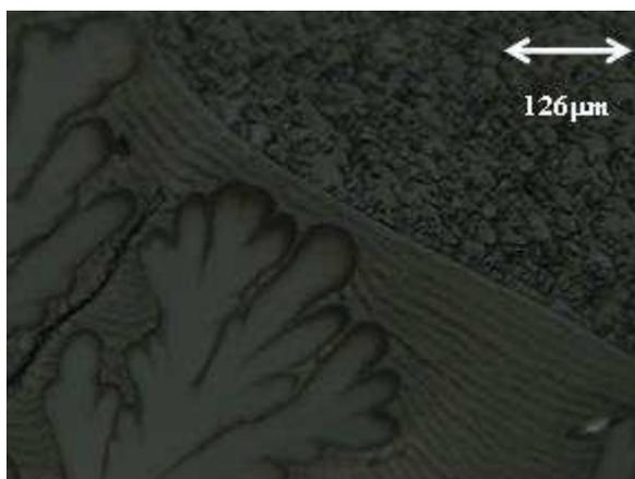
**Figura 29 - Imagem obtida por microscopia ótica do PMMA irradiado com 100kGy, ensaiado na velocidade de alongamento de 0,2 mm/min, sob etanol.**
