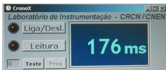
Figura 11. Tela do software para leitura do tempo de exposição do Cronox.
