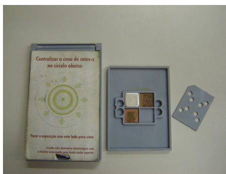
Figura 8. Protótipo do Cartão Dosimétrico Odontológico.
