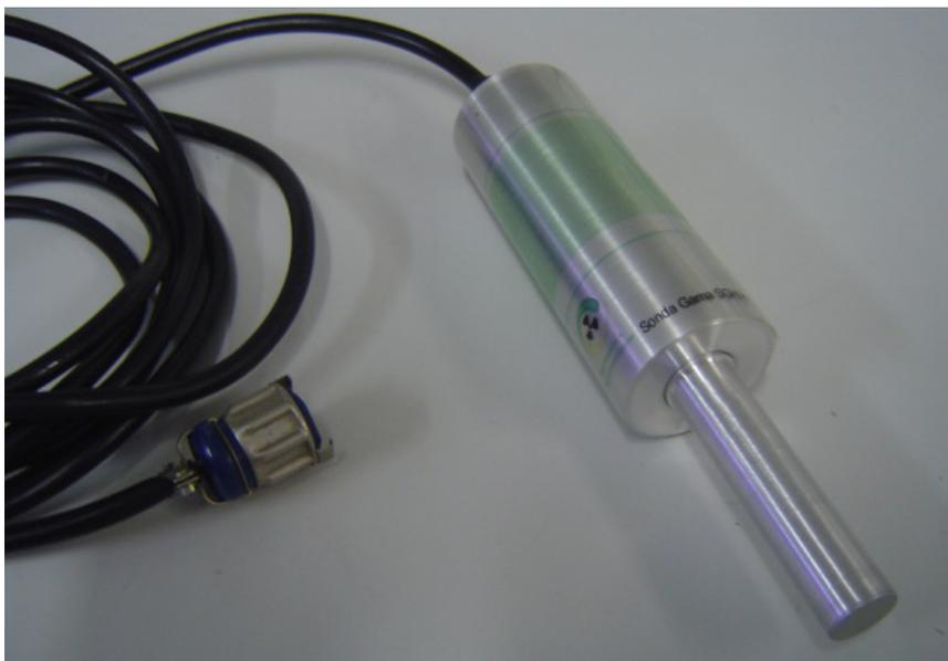
**Figura 42: Sonda Gama SGHI-01 desenvolvida no DEN-UFPE.**
