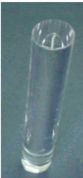
Figura 34: Guia de luz de 7,5mm de diâmetro por 60 mm de comprimento confeccionado de polimetilmetacrilato (PMMA).
