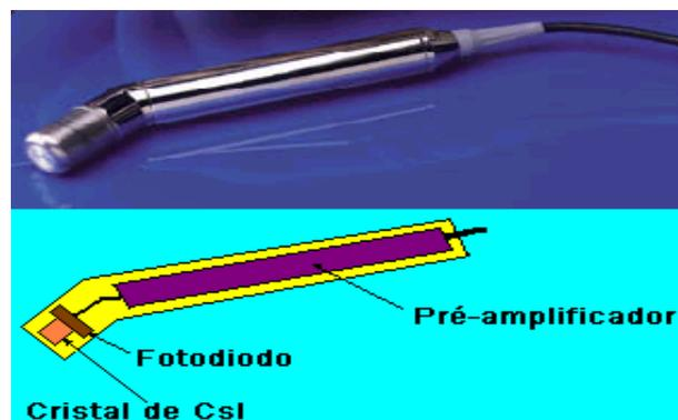
**Figura 47:** Sonda gama, da marca EUROPROBE.
