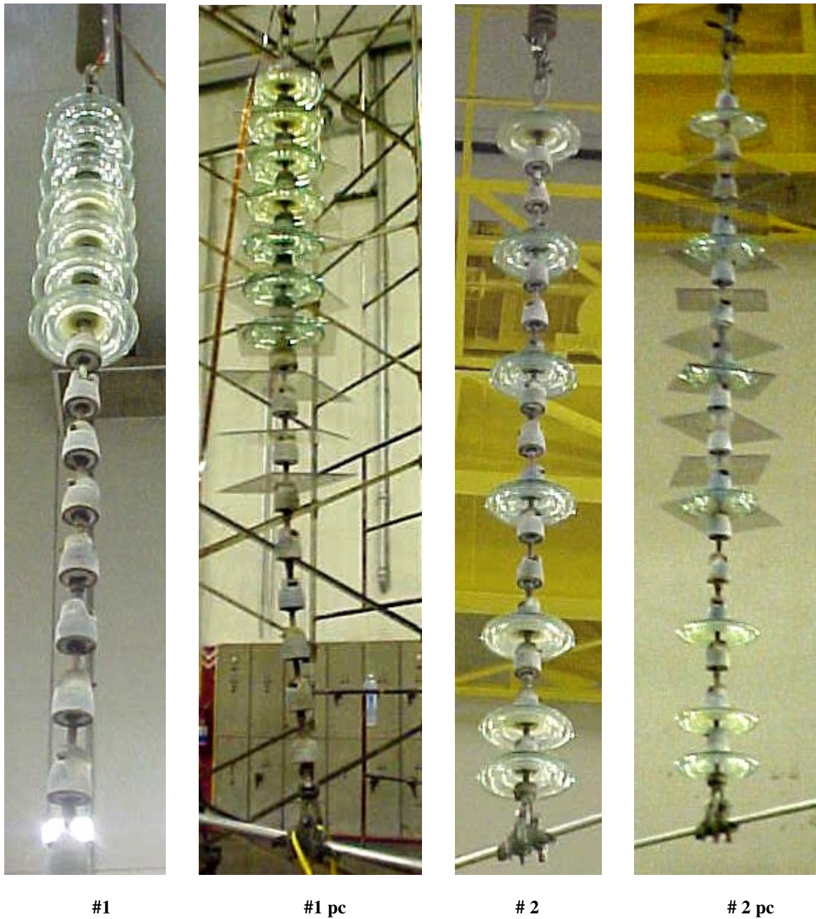
Figura 17. Configurações do ensaio de alta tensão. (#1) Arranjo n° 1. (#1pc) Arranjo n° 1 com escudos de PC. (#2) Arranjo n° 2. (#2pc) Arranjo n° 2 com escudos de PC.
