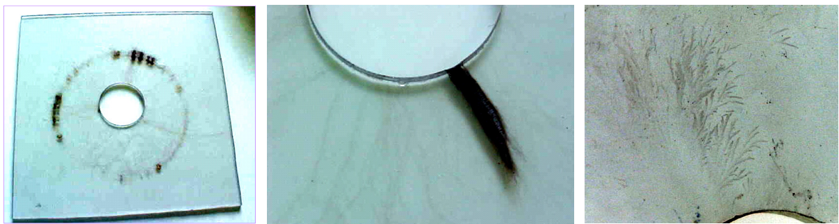
Figura 27. Fotografias de alguns escudos de PC que apresentaram sinais de carbonização superficial, após experimentos de alta-tensão.
