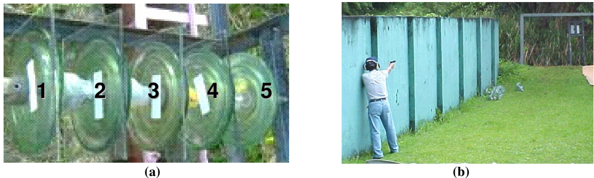
Figura 19. Configurações do ensaio balístico. (a) Cadeia com 5 isoladores de vidro e escudos de PC. (b) Atirador posicionado para o disparo.
