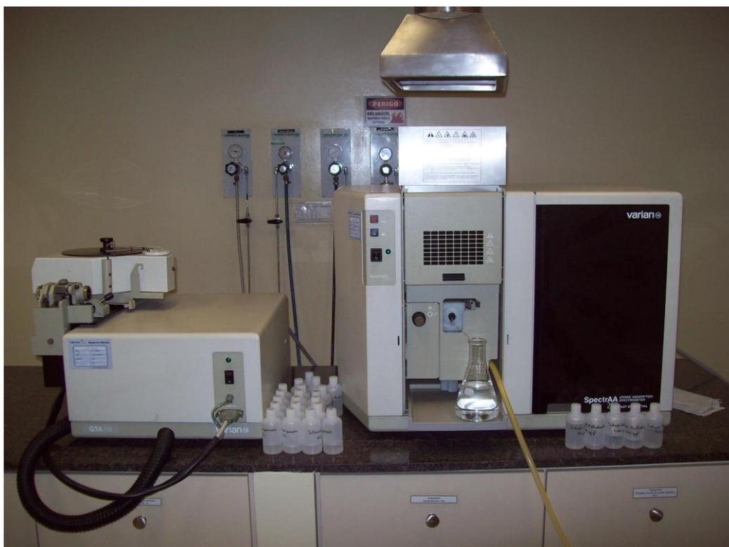
**Figura 10** - Espectrofotômetro de absorção atômica com forno de grafite acoplado.
