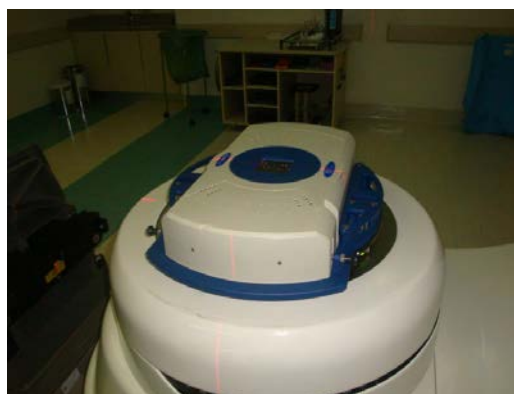
Figura 11 – Acelerador Linear com o acoplamento do micromultileaf para radiocirurgia.
