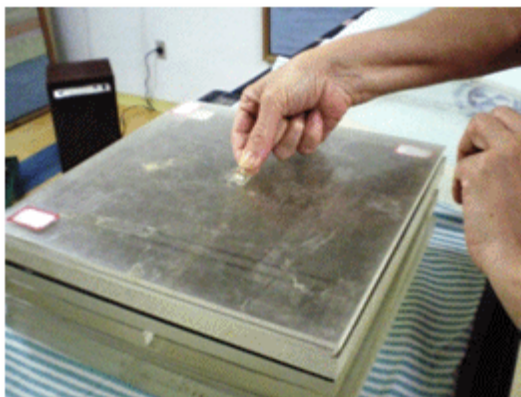
Figura 25 – Colocação do TLD sobre o phantom .
