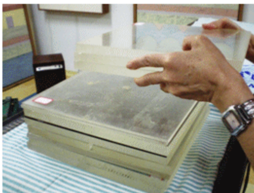
Figura 26 – Colocação de placas de acrílico sobre o dosímetro.
