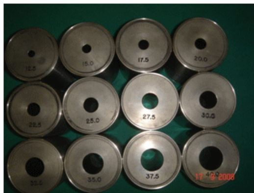
Figura 21 B – Diâmetros dos colimadores (12,5 a 40 mm).
