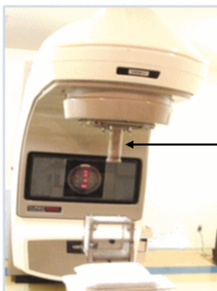
Figura 9 A – Acelerador Linear com o acoplamento do colimador para radiocirurgia.
