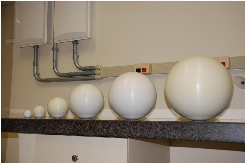
*Figura 9: Apresentação do conjunto de esferas de polietileno do sistema EB utilizado neste trabalho.*
