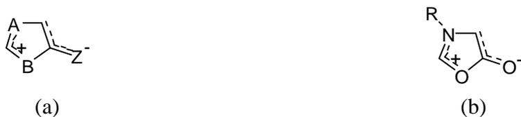
**Figura 1.5.** a) representação dos anéis mesoiônicos estudados nesta tese segundo a definição mais recente de compostos mesoiônicos do tipo A<sup>65</sup>, os grupos A e B podem ser substituídos por O, S ou NR e o grupo Z poder ser substituído por O, S, NR ou CR<sub>2</sub>; b) representação da molécula (7) segundo a definição mais recente de compostos mesoiônicos do tipo A.
