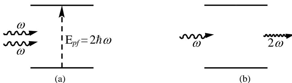
**Figura 1.1.** a) Representações diagramáticas dos processos de (a) absorção de dois fótons e (b) geração de segundo harmônico óptico.
