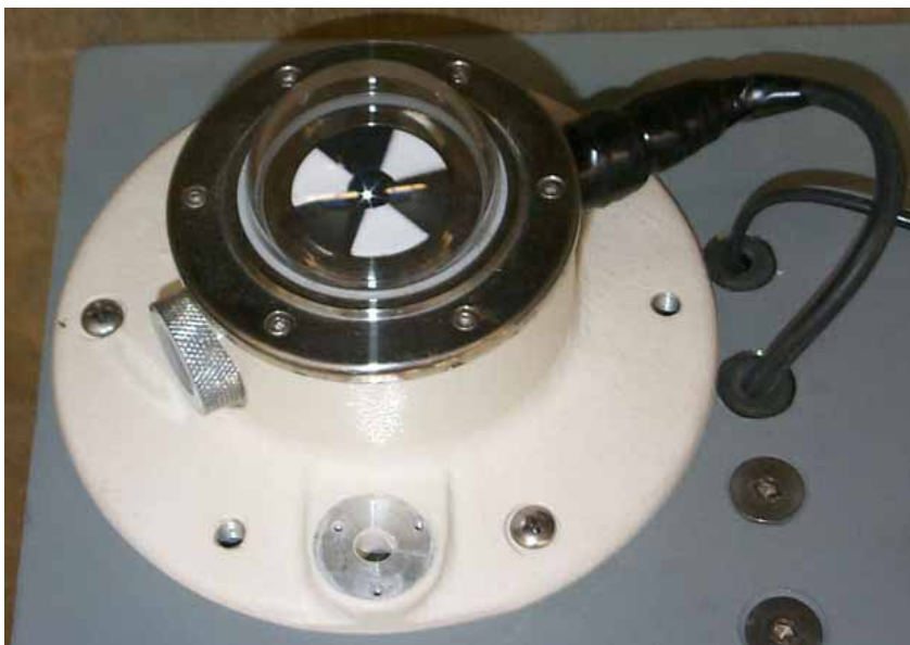
Figura 17 – Piranômetro Eppley preto e branco.
