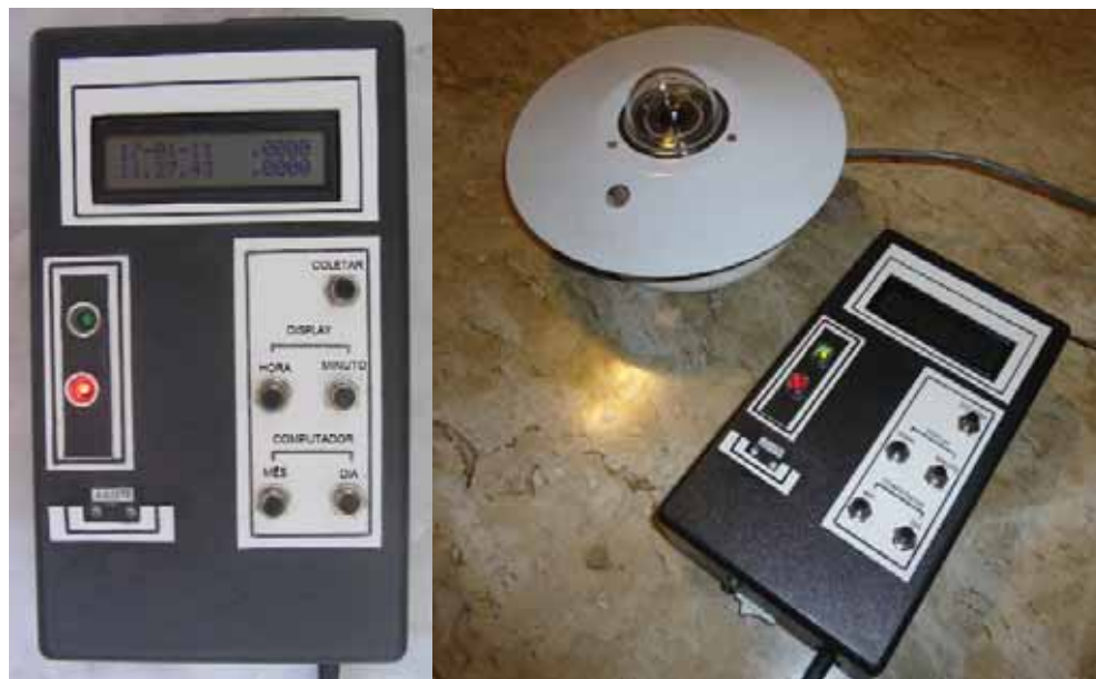
Figura 63 – Vista frontal do coletor de dados e do sensor para medição da radiação global.
