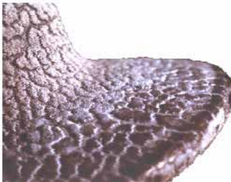
Figura 4 – Fissuras na superfície de um isolador polimérico.
