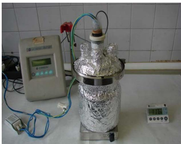
**Figura 6.3 - 1.** Fotoreator anular com lâmpada UVA e a montagem experimental empregados no estudo do processo foto-Fenton para o *GCV*
