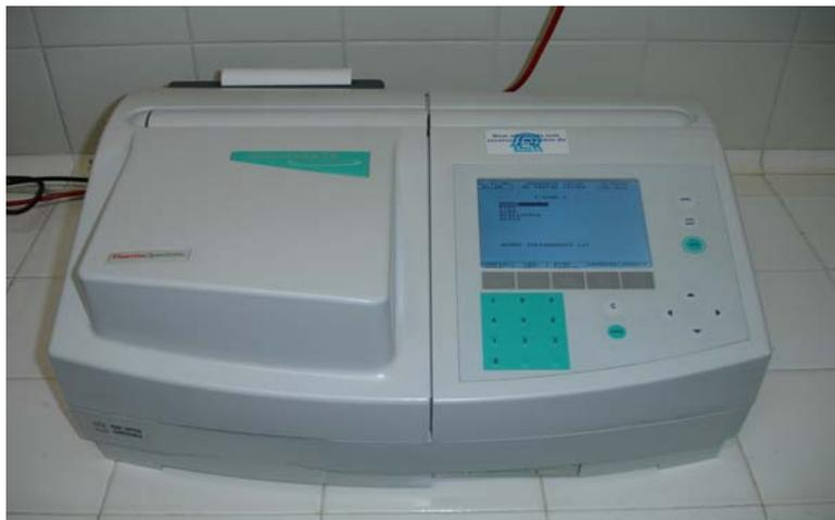
**Figura 4.1 - 1.** Espectrofotômetro UV-Visível (Aquamate - Thermo Spectronic)
