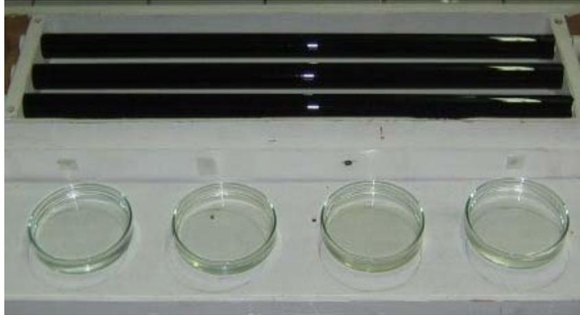
**Figura 5.1 – 3.** Reator – Luz UVA com amostras da solução aquosa do *RR RB-133* após a reação foto-Fenton
