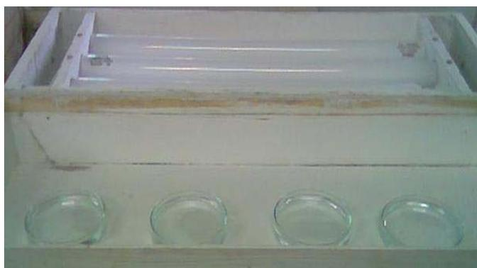
**Figura 5.1 – 5.** Reator – Luz Visível com amostras da solução aquosa do *RR RB-133* após a reação foto-Fenton
