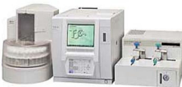
**Figura 6.1 - 2.** Analisador de COT (TOC  $V_{\text{CSN}}$  da Shimadzu)
