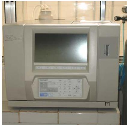
**Figura 4.1 - 2.** Analisador de COT (TOC V<sub>CSH</sub> Shimadzu)
