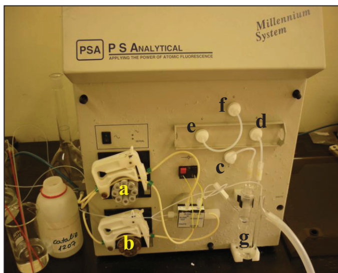
Figura.33- Espectrômetro de fluorescência atômica com geração de vapor frio. a) Bomba peristáltica 1; b) Bomba peristáltica 2; c) porta de saída do gás carregador conectada ao separador gás-líquido; d) entrada do vapor de \text{Hg}^0 no sistema de secagem; e) porta de saída do sistema de secagem; f) porta de entrada da amostra para o detector.
