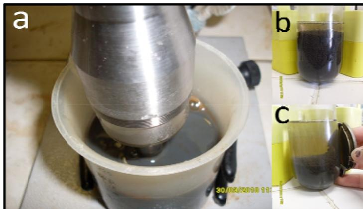
**Figura 20:** (a) foto do material instantes após a adição do NaOH durante a síntese no ULTRA 3, (b) instantes antes da centrifugação e (c) quando submetido ao campo magnético externo.
