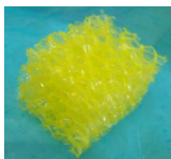
Figura 3. 1. Esponja polimérica utilizada na confecção das cerâmicas porosas reticuladas.
