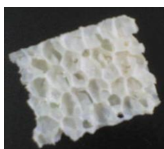
Figura 3. 2. CPR preparada com composição #2, após sinterização a 1200°C e antes da impregnação com TiO 2 .
