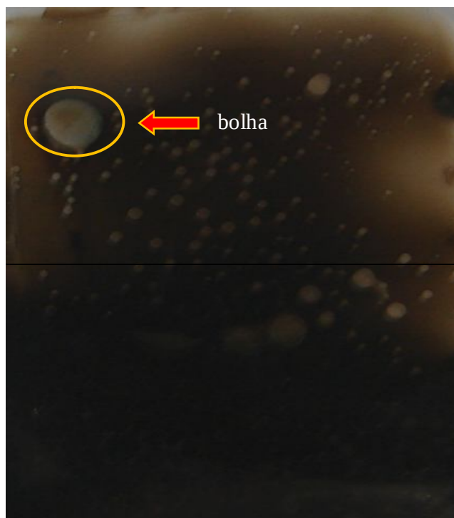
Figura 33: Amostra de gel (AlPP) dopado com 1,07 \times 10^{-4} mol de C_6H_5NH_2 e 6,0 \times 10^{-4} mol de Ag^+ , após exposição a dose de 70 kGy.
