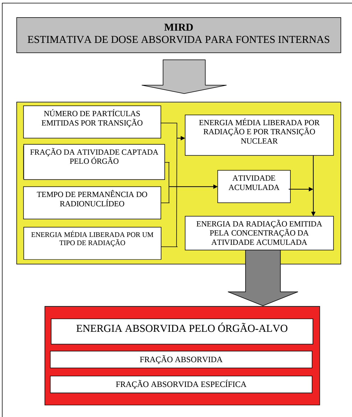
Figura 5: Diagrama de blocos para a estimativa da dose absorvida em um determinado órgão, para fontes internas, no modelo MIRD.
