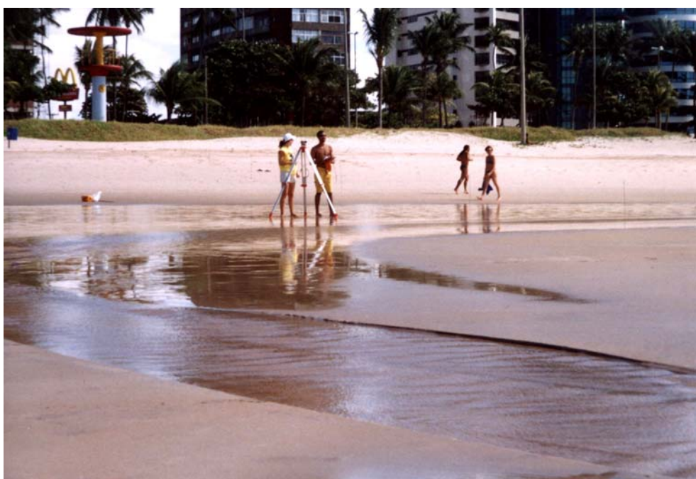
Foto 3 - Utilização do Nível Pentax AL 240B nos trabalhos de campo, no perfil 2, mês de Julho de 2003 (Foto do autor, 2004)
