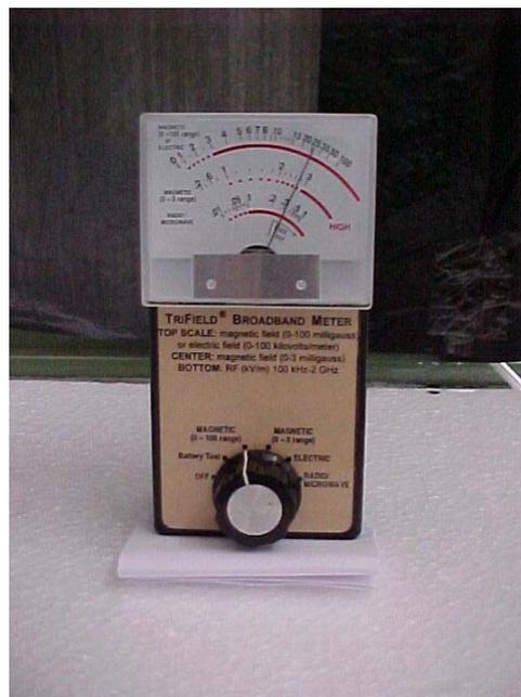
Figura 4 - Gaussímetro registrando 30 mG ( $3\mu\text{T}$ ), sobre o suporte onde a gaiola foi colocada.
