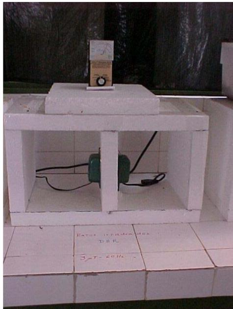
Figura 1 – Demonstração do suporte utilizado para a colocação das gaiolas, com o transformador embaixo e com o Gaussímetro registrando a intensidade adequada para a exposição dos ratos.
