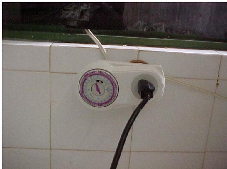
Figura 2 – Demonstração do *timer* eletrônico utilizado.
