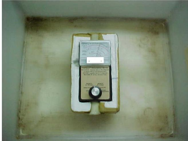
Figura 5 – Demonstração do gaussímetro marcando  $3\mu\text{T}$  na região central da gaiola.
