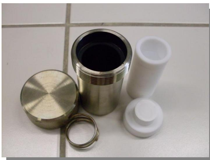
**FIGURA 2.7:** Reator utilizado na síntese dos compostos.
