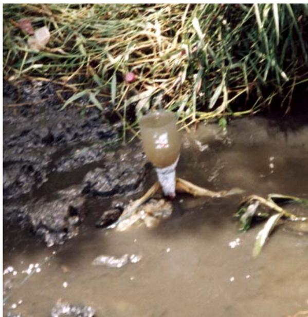
Figura 07- Armadilha para captura de sedimentos com o material sedimentado.
