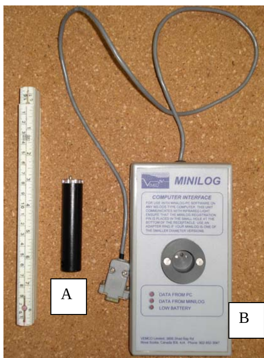
Figura 08 - Em A - Minilog TDR (Temperature and Depth Recorder), em B - Interface para programação e transferência de dados para o computador. (Foto: Arley Andrade).
