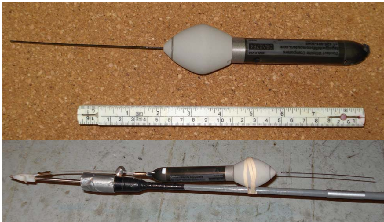
Figura 06 - Marca PSAT da Wildlife Computers, mostrando o sistema de fixação da mesma no peixe (Foto: Arley Andrade).
