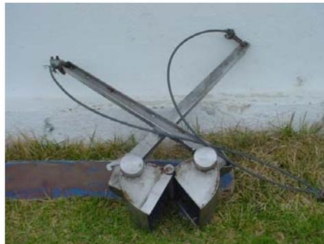
Foto 5: Amostrador de sedimentos superficiais do tipo van Veen.
