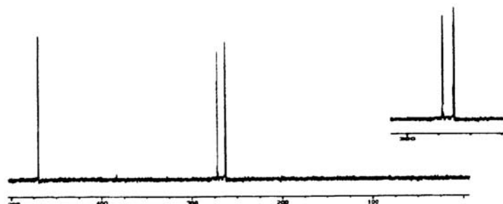
Figura 17: Espectro se ^{77}\text{Se} (57 MHz) da mistura obtida a partir da reação de selenociclofuncionalização
