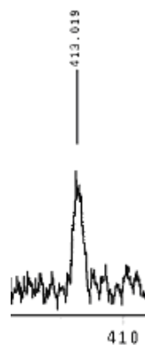
Figura 31: Espectro de RMN ^{77}\text{Se} ( \text{CDCl}_3 , 57 MHz - partes) do ácido 9 após a adição de um equivalente de ( \pm )-MBA.
