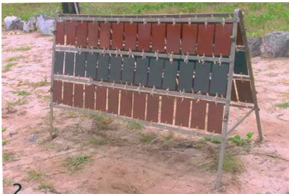
Figura 05: Cavalete em aço inoxidável que sustentou o conjunto de placas metálicas durante o experimento
