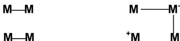
Figura 8. Esquema mostrando a ressonância não-sincronizada.
