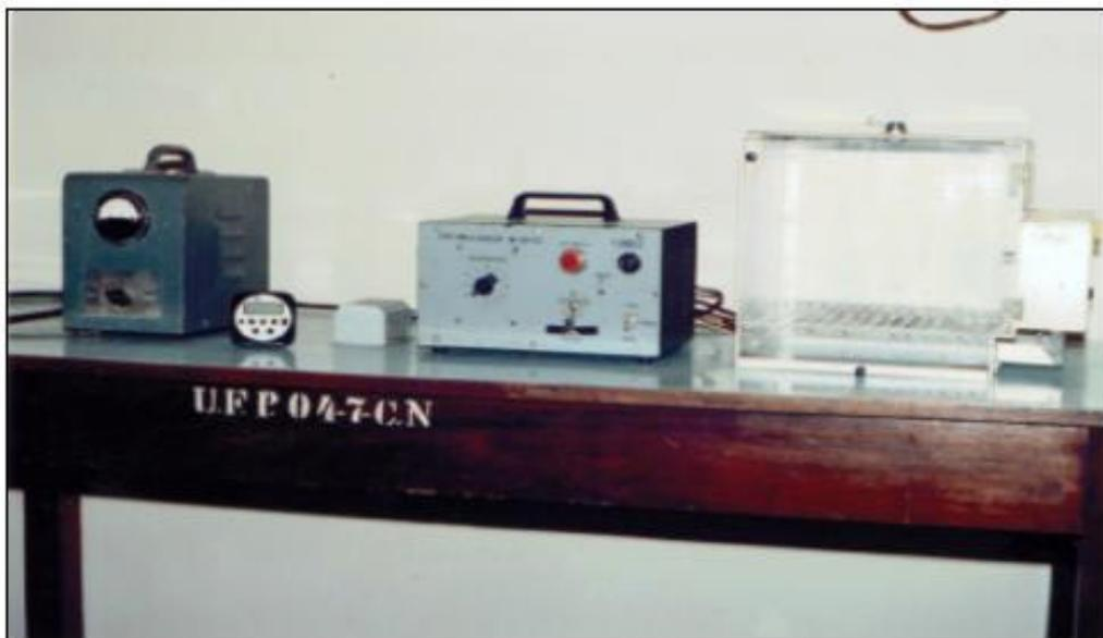
Foto 2 – Caixa de Skinner, onde o comportamento agressivo é induzido por choque elétrico 1,6 mA em 2s nas patas dos animais.
