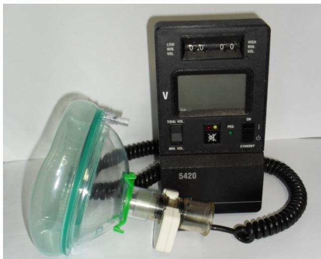
Figura 4: Ventilômetro digital - Ohmeda® 5420 (Finlândia)
