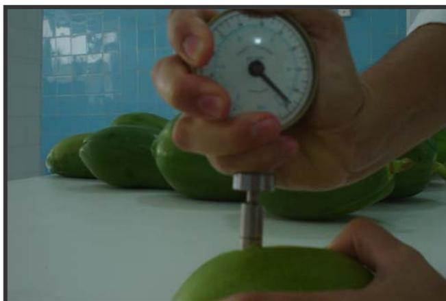
Figura 06: Determinação da firmeza.
