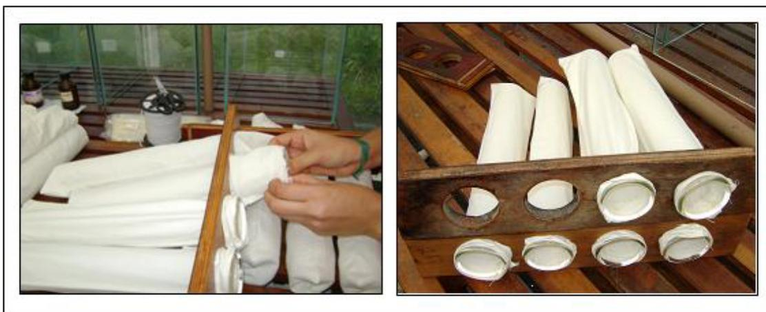
Figura 4 - Diferentes ângulos das provetas de vidro, revestidas com saco de algodão, utilizadas no sistema de simulação de biorremediação instalado no Galpão do Laboratório de Geoquímica da Universidade Federal da Bahia. Fonte: Laboratório de Geoquímica da Universidade Federal da Bahia.
