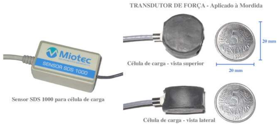
Figura 4: Foto ilustrativa da célula de carga utilizada na verificação da força de mordida. São Paulo, 2008.
