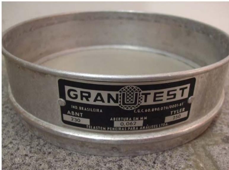
Figura 08. Peneira para sedimento, abertura da malha 0,062mm.
