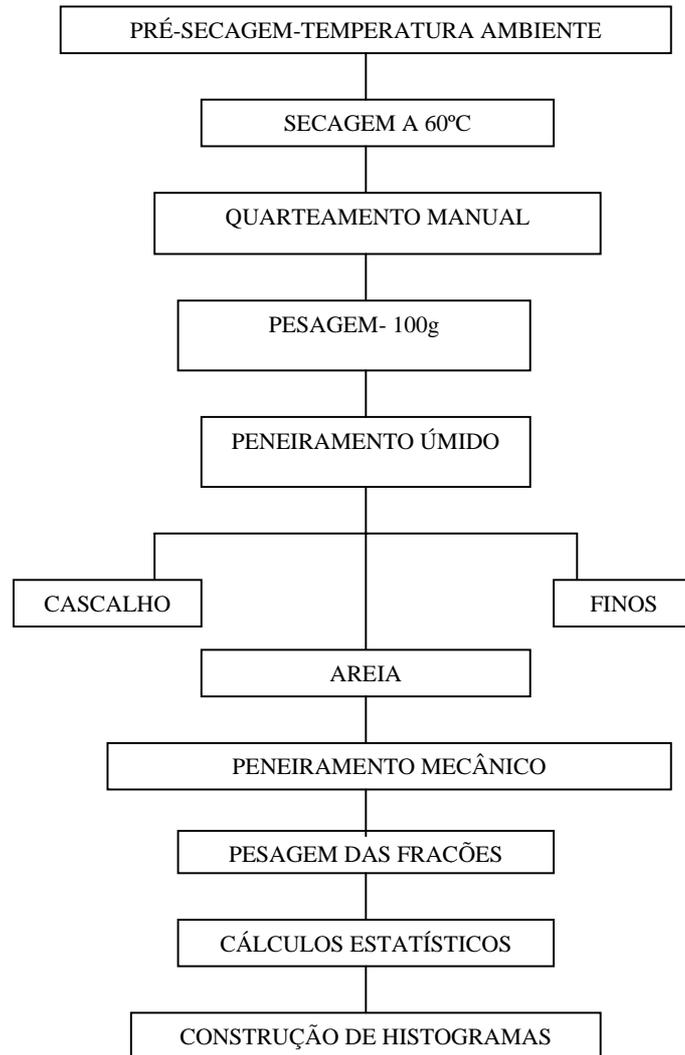
Figura 11. Fluxograma do método empregado para análise granulométrica.
