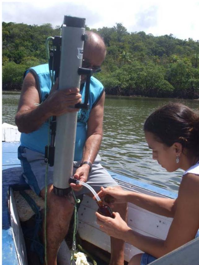
Figura 06. Coleta de água para análise de parâmetros hidrológicos.
