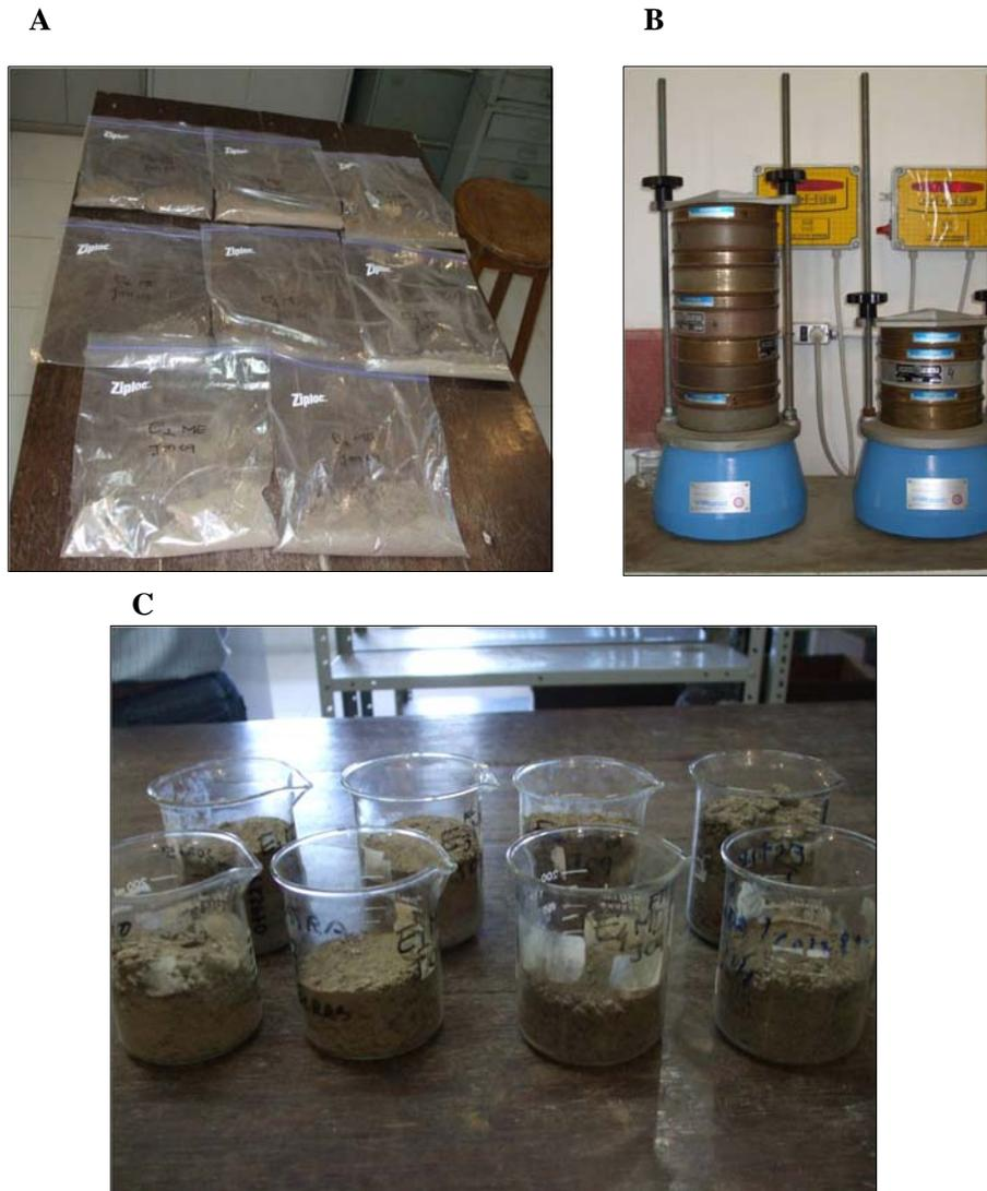
Figura 12- Materiais utilizados no procedimento de análise granulométrica.
