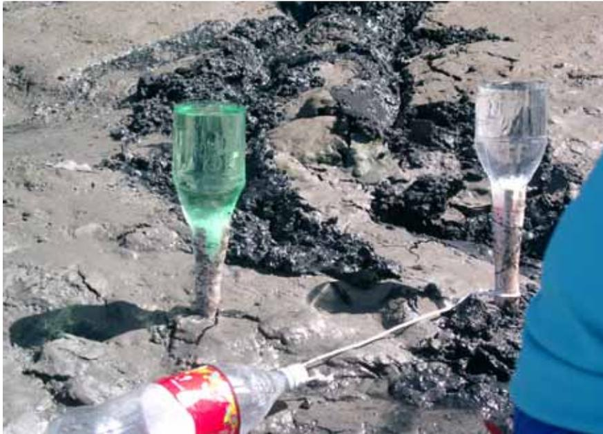
Figura 07- Armadilha para captura do material sedimentado nas 24h.
