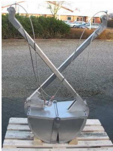
**Figura 3:** amostrador de sedimentos do tipo van Veen.
