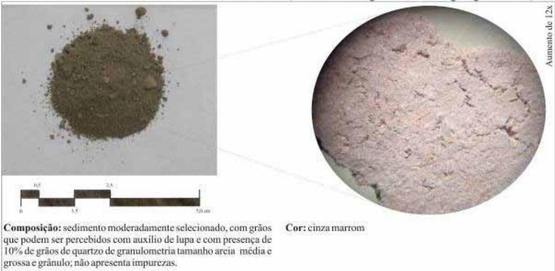
Figura 056. Resultado do exame macroscópico da amostra 098. Fonte: Figura pela autora.
