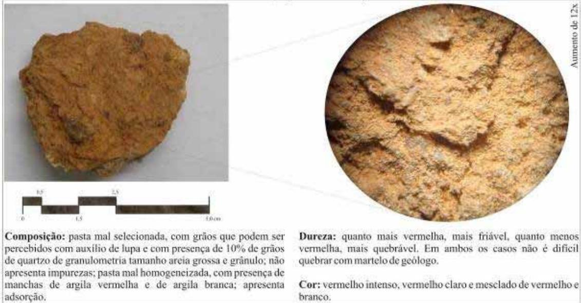
Figura 043. Resultado do exame macroscópico da amostra 089. Fonte: Figura pela autora.
