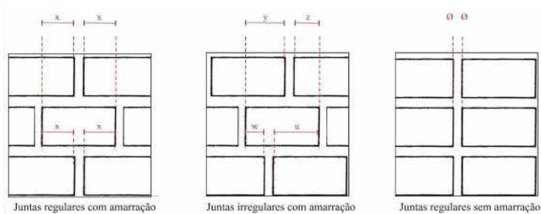
Figura 010. Exemplos de diferentes disposições de “juntas na posição vertical”. Fonte: Figura pela autora.
