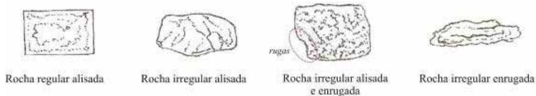
Figura 06. Exemplos de tratamento de superfície em rochas para construção de edifícios.
