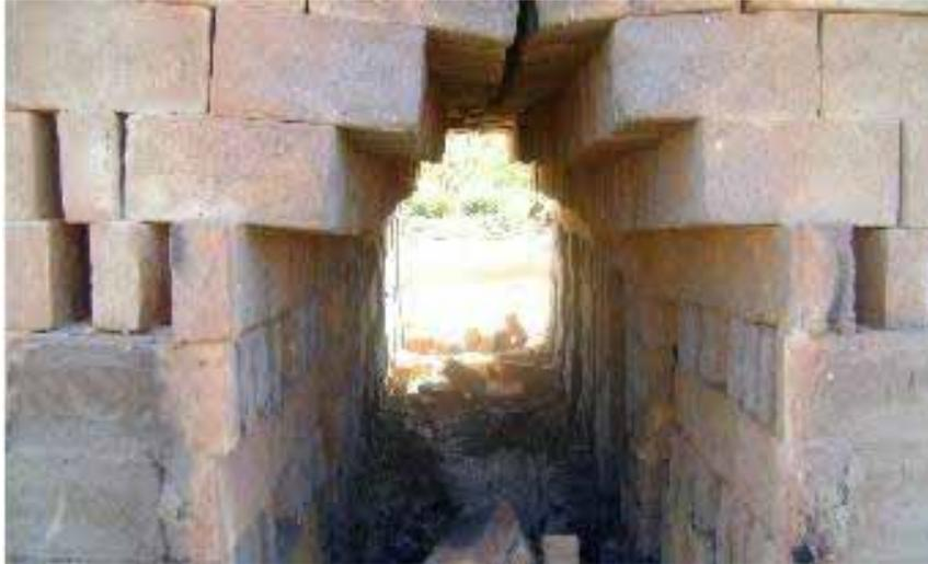
Foto 05. Exemplo de queima de tijolos maciços, onde o forno é resultado da organização dos tijolos. Fonte: olariatudo em [http://www.griootzen.com/index.php?base\\_principal=base&id\\_base=8](http://www.griootzen.com/index.php?base_principal=base&id_base=8).
