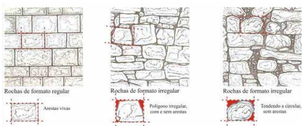
Figura 08. Formatos de rochas utilizadas na construção de edifícios. Regulares e irregulares. Fonte: Figura pela autora.
